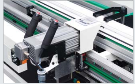
İspanyolet kanal açma / Фрезерование паза под механизмы
