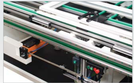
Otomatik ispanyolet kesim Автоматическое отсекание фурнитуры
