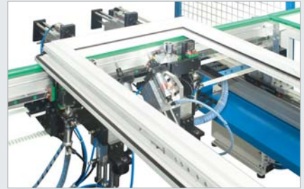
Dörtlü su tahliye sistemi Система фрезерования дренажных отверстий с 4 двигателями
