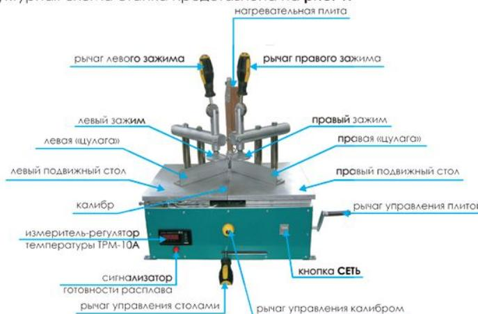
Рисунок 1- Структурная схема
